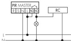
Lors du branchement d'inductances parallèles au réseau (lampes fluorescentes, contacteurs, etc.), un circuit RC peut être nécessaire.
