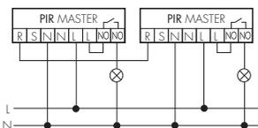
Subdivision d'une grande zone de détection en différentes zones d'éclairage avec mesure individuelle de la luminosité.
