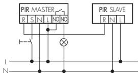
La lumière peut être allumée ou éteinte manuellement en fonction des besoins par un appui court sur le bouton poussoir. Agrandissement de la zone de détection avec un ou plusieurs appareils Slave. Attention: L'appareil Master doit toujours être monté à l'endroit où la quantité de lumière est la plus faible.
