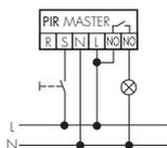
La lumière peut être allumée ou éteinte manuellement en fonction des besoins par un appui court sur le bouton poussoir. (Attention: les boutons poussoir lumineux sans neutre ne peuvent pas être gérés).
