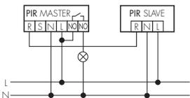
Agrandissement de la zone de détection avec un ou plusieurs appareils Slave. Attention: L'appareil Master doit toujours être monté à l'endroit où la quantité de lumière est la plus faible.
