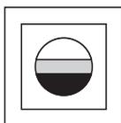
Cache clipsable pour couvrir la zone de détection verticale avec montage encastré (UP)/apparent (AP) pour masquer les sources de brouillage au dessous de l'appareil (par ex. petits animaux, etc.)
