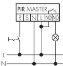
Permet l'allumage manuel de l'éclairage raccordé. Attention: la lumière doit ensuite être éteinte manuellement.
